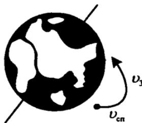
Из того, что спутник кажется неподвижным относительно Земли, следует, что его угловая скорость равна угловой скорости вращения Земли:
